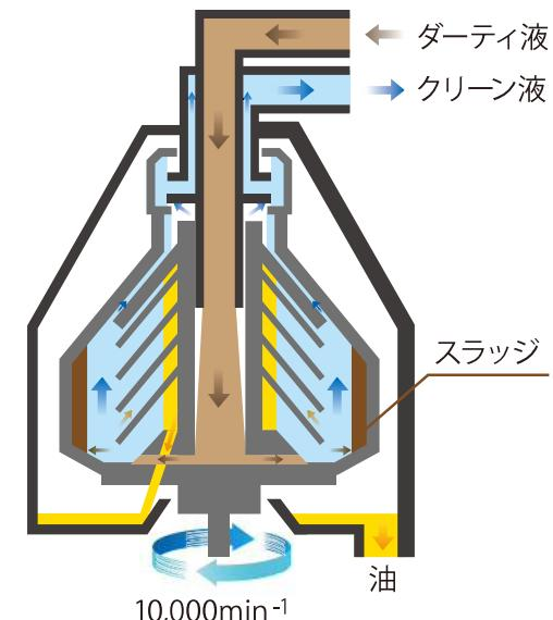
毎分 10,000 回転で高速回転するボウルにダーティ液が入るとその強烈な遠心力で水・油・スラッジに分かれます。
