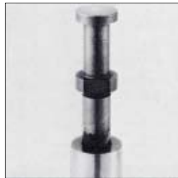
プランジャ・バレル写真 磨耗によりスカスカに なっている。
