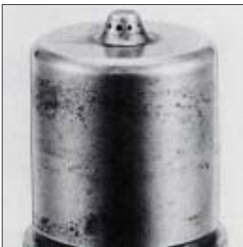
ノズルチップ写真 磨耗により穴径が 大きくなっている。
