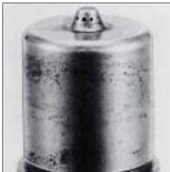
ノズルチップ写真 磨耗により穴径が 大きくなっている。
